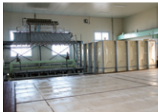
製氷された氷は型ごとクレーンで引っかけ写真奥のプールへ（プールに入ると自然に型から氷は外れる）
