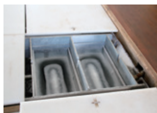
水を型に流し込む際、コンプレッサーで空気を入れ泡立てることで透明な氷を作る
