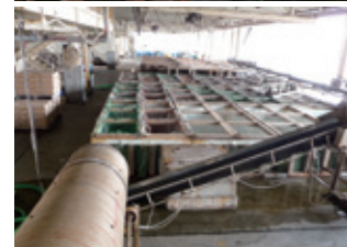
水揚げされたワカメをボイル、海水中で冷却を繰り返す。何台ものローラで水分を絞り、塩を絡めてドラムの中で攪拌（写真上）。その後、木枠の中で漬け込み（写真下）1tのコンクリートの重しで水を絞り、その後出荷作業にまわす。以上の海藻加工機器類を助成で購入（普代村太田名部漁港）
