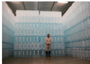
型からはずれた氷はクレーンで貯氷施設に運ばれ大量に保管する
