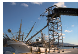
製氷施設から直接コンベアで船に氷を積み込む
