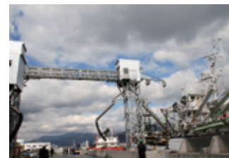
新しい製氷施設から直接、船の中に氷を供給
