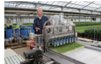
スポンジに種をまき芽が出たところを機械で切り取る
