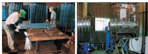
ロールボックスパレット(左)、コールドボックス(右)の修理。パーツごとに分解して、曲がりや歪みの修正、溶接、キャスター交換などを行う
