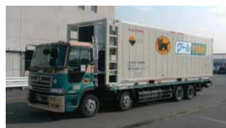
二温度帯対応の鉄道クールコンテナ。この取り組みは、2005年10月にグリーン物流パートナーシップ会議モデル事業に認定されています
