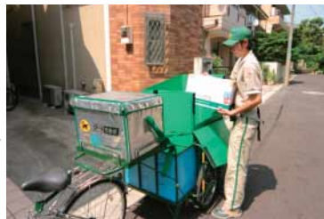
専用カバー付きリヤカーには100kg以上積載可能。自転車は特注スタンド付きで、積み卸し時も安心です
