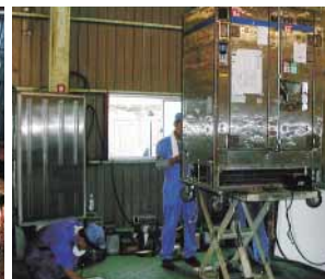
ロールボックスパレット(左) コールドボックス(右)の修理。パーツごとに分解して、曲がりや歪みの修正、溶接、キャスター交換などを行います
